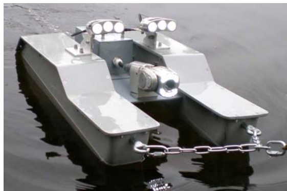
Hình 2: Thiết bị quan sát điều khiển từ xa nổi trên mặt nước - Telerobot-N3
